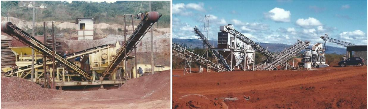
Fig. 8 - Fotos de Instalações de Britagem (alimentação, britador, correias e peneira)
