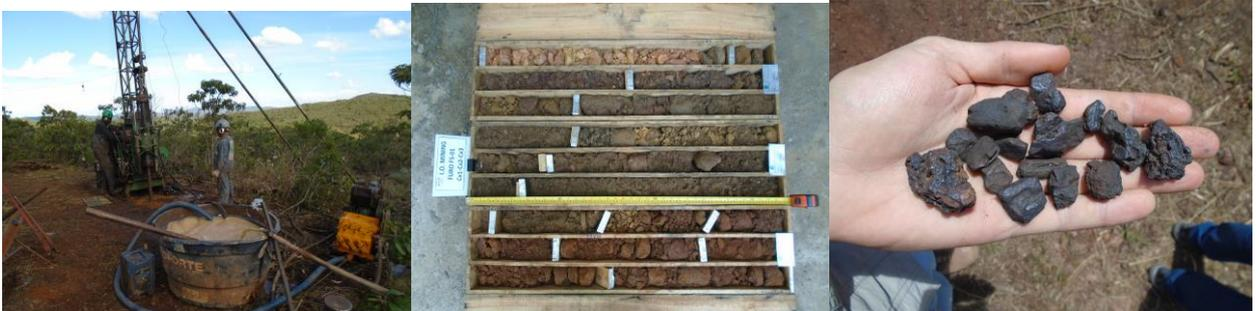
**Fig. 7 - A sonda em operação e os testemunhos em caixa padronizada para descrição e amostragem e os grânulos de hematita soltos na superfície.**
